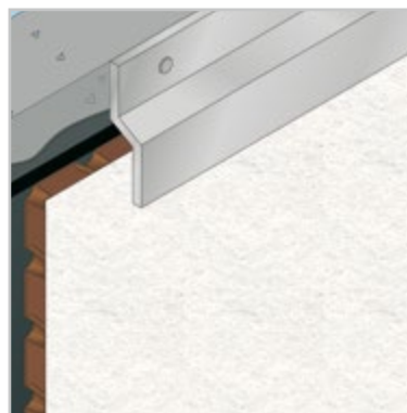
Fixação com o perfil metálico superior.
